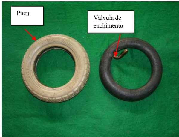
Elementos de borracha da nova roda
